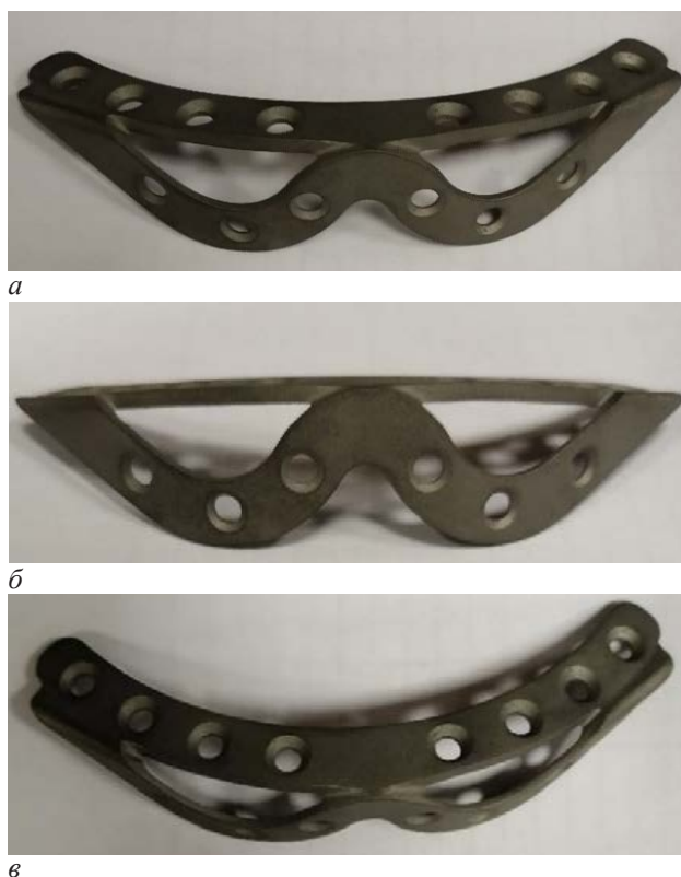
Рис. 7. Оригинальная пластина, созданная с применением аддитивных технологий: а – общий вид пластины; б – вид спереди; в – вид сверху
