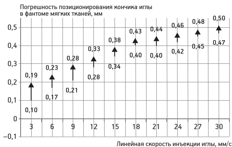
Рис. 2. График зависимости погрешности позиционирования кончика иглы в фантоме мягких тканей пациента от линейной скорости введения иглы
