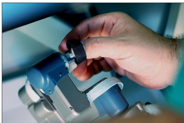
Рис. 4. Джойстики управления на консоли робота da Vinci
