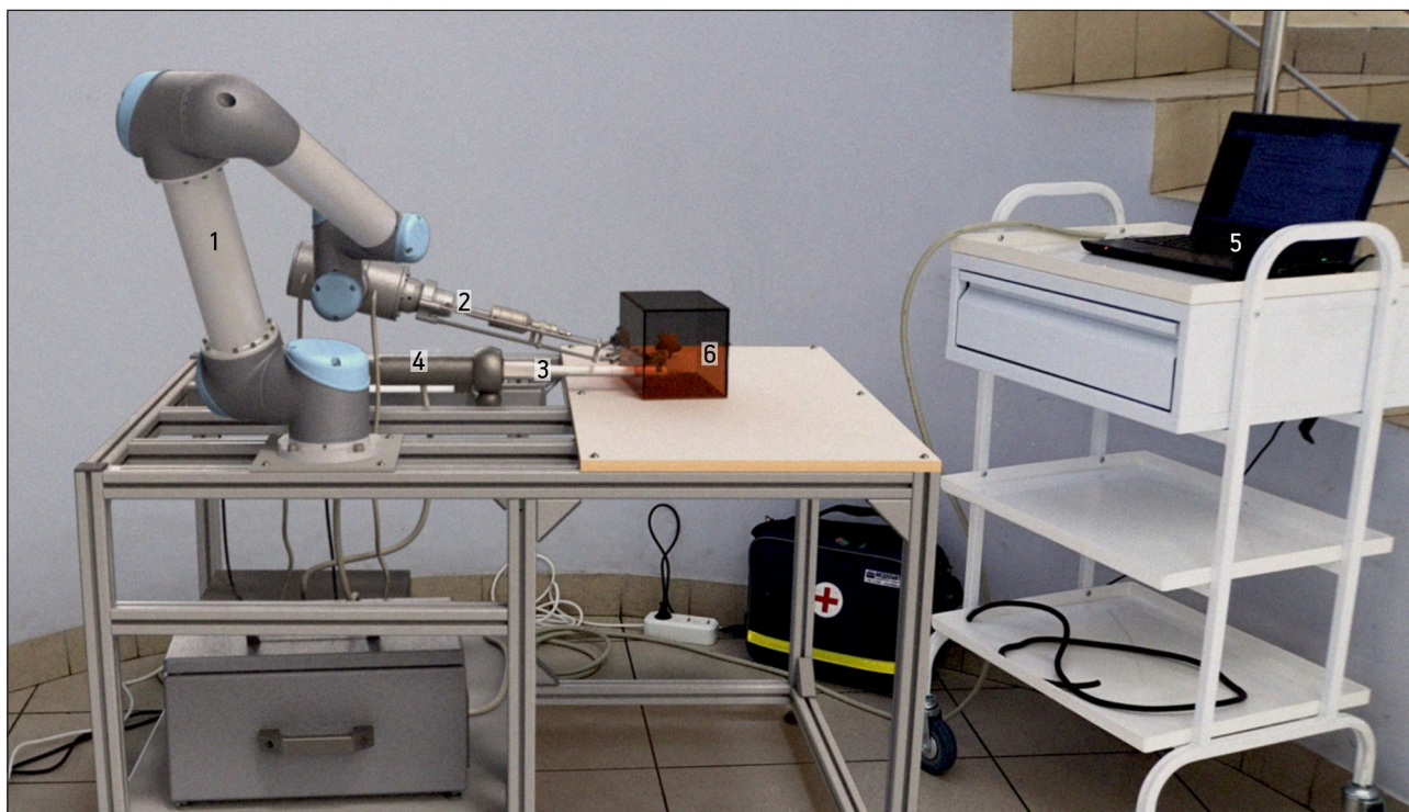
Рис. 1. Схема экспериментального стенда с разработанной роботизированной системой для брахитерапии (объяснения в тексте)
