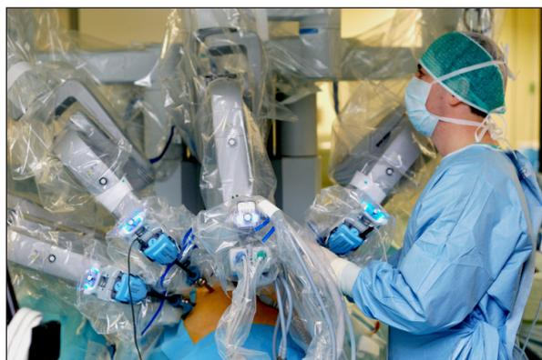
Рис. 2. Манипулятор робота da Vinci
