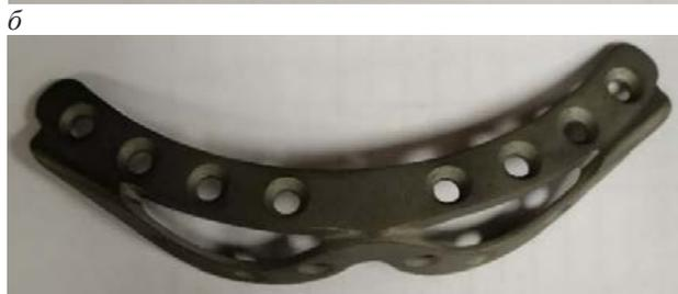
Рис. 7. Оригинальная пластина, созданная с применением аддитивных технологий: а – общий вид пластины; б – вид спереди; в – вид сверху
